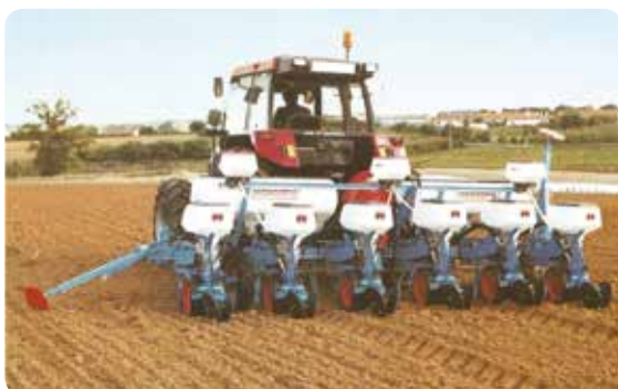
Rys. 1 Siewnik Monosem przystosowany do wysiewu mikro-granulat
